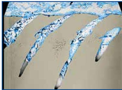
Imagen de fusión de nuevos datos que combina los datos de imagen 3D superpuestos con los datos de estaño de EMISD (azul) de la misma muestra
